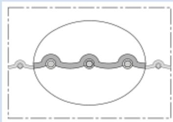
Résistant à l'abrasion, gaine de protection en polyuréthane robuste et résistante aux huiles, étanche aux liquides; spirale: fil d'acier revêtu de plastique
